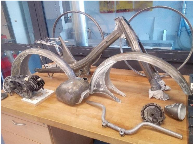
Um auch letzten Porenrost zu beseitigen, kam Phosphorsäure zum Einsatz. Mit Zangen, Gummihammer, Treibhammer und verschiedenen, eigens angefertigten Holzwerkzeugen wurden dann Schutzbleche und Verkleidungen ausgebeult und geglättet.
