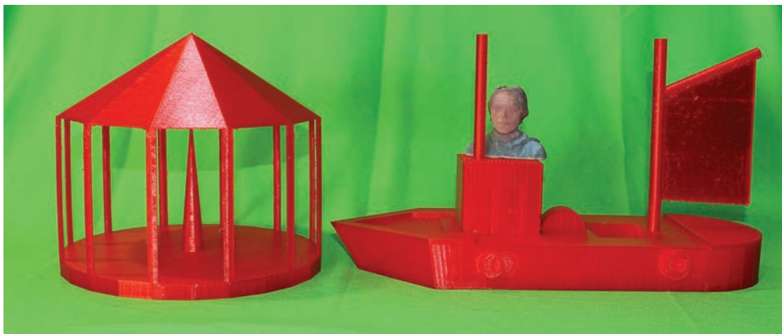
Karussell und Segelboot. Schülerproduktionen aus 2015, angefertigt mit der Software Sketchup, ausgedruckt am Felix-3D-Drucker.
